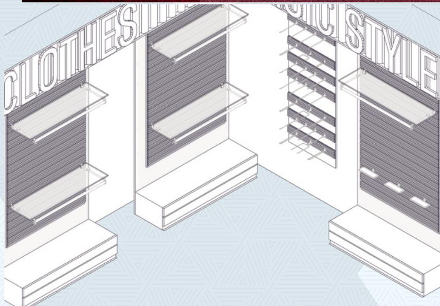
El perfil ranurado que integra este sistema es capaz, por adición, de generar paneles ranurados totalmente de aluminio, con la versatilidad y durabilidad que ello implica. Es el sistema ideal para realizar destaques dentro de la sala de ventas y sacar partido de pequeños espacios residuales. La amplia gama de accesorios que lo acompañan colabora en este sentido.
