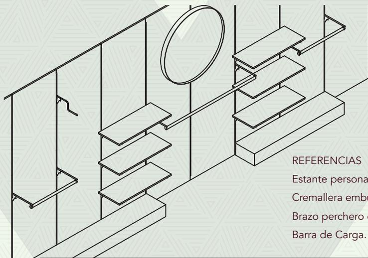
Integrado por un perfil vertical de apenas 7mm de vista que se inserta en placas de hasta 18mm de espesor. La variedad y sutileza en el diseño, tanto del perfil como de los accesorios, dan lugar a una exhibición minimalista y elegante.
