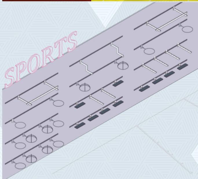
Compuesto por un perfil horizontal de aluminio de 1,50m de longitud que se encastra entre placas con una vista de solo 15mm de altura. Como todo sistema de exhibición horizontal, es capaz de reforzar la profundidad y direccionalidad del espacio, a la vez que consigue una disposición flexible de los productos, reforzada por la variedad de accesorios también de aluminio.
