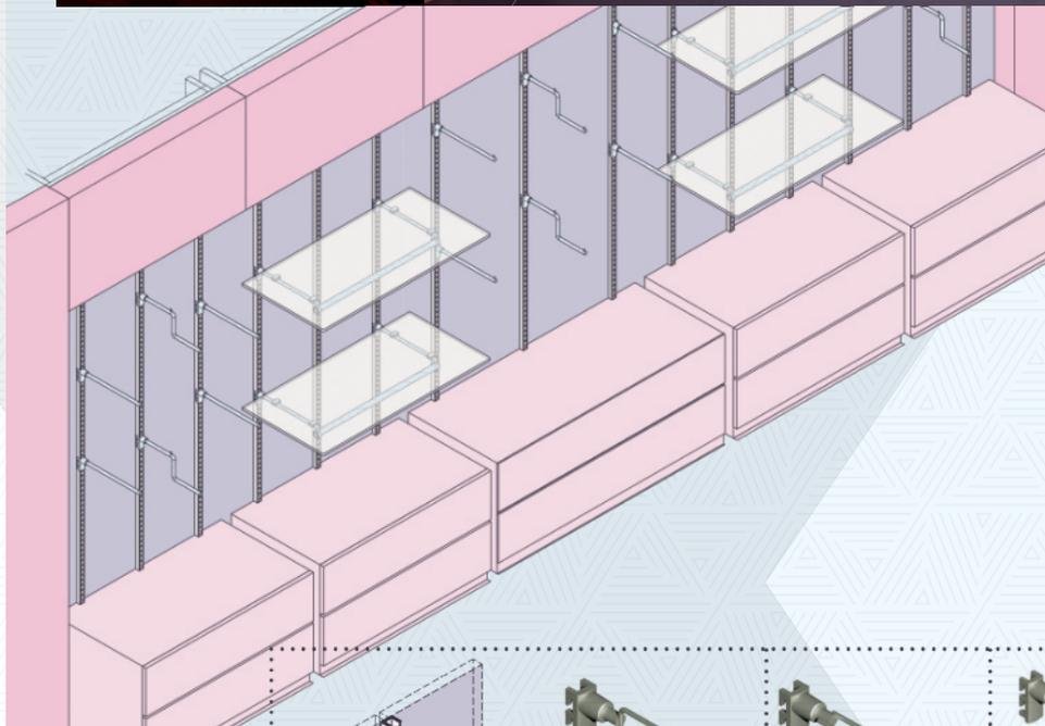
El perfil de tipo escalerilla es el elemento principal de este sistema, y constituye una variante novedosa y acabada en sí misma, a la vez que permite su personalización mediante la incorporación en su interior de una cinta de PVC con color. Pudiendo colocarse entre placas o sobrepuesto, cuenta con una amplia variedad de accesorios para diferentes usos.
